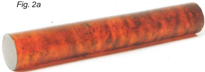
Fig. 2a - Cilindro in ambra pressata (o ricostituita), linea guida 2. Dimensioni in cm: 13 x 3 circa. Campione e foto di G. L. Cattaneo.
