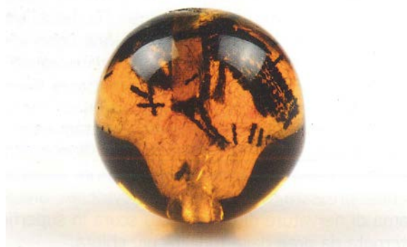
Fig. 5 - Campione di falso di ambra (linea guida 2) i cui parametri fisici inducono a definire “poliesterre”. Per gentile concessione del CISGEM. All’interno è presente tessuto sintetico bruciato. Diametro della sfera: 1 cm circa. Foto di R. Appiani.
