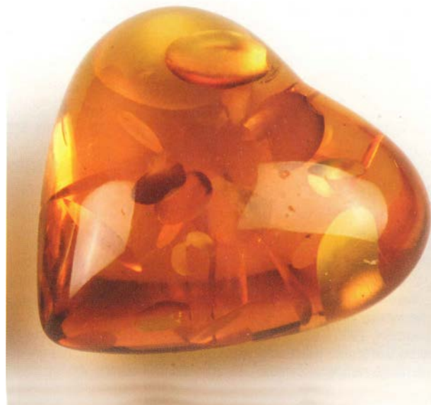
Fig. 4 - Campione di falso di ambra (linea guida 1) i cui parametri chimico-fisici inducono a definire polybern. Per gentile concessione del CISGEM. In accordo con il gemmologo Enrico Butini (IGN) riteniamo che la presenza (voluta) dei dischi (non raggiati) sia dovuta a riscaldamento con olio.
