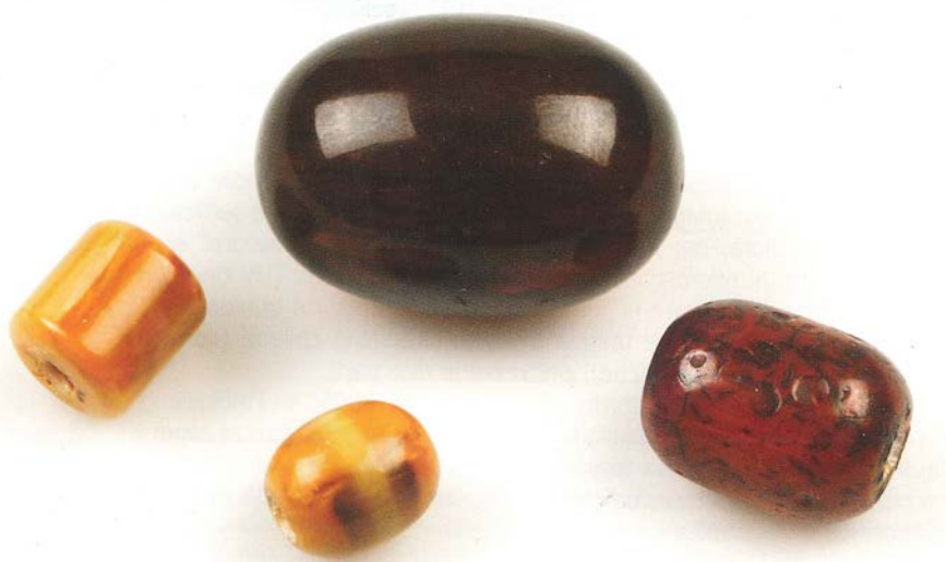
Fig. 8 - Campione di falso di ambra (linea guida 4) i cui parametri fisici inducono a definire "bachelite". Per gentile concessione del CISGEM.
